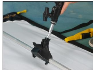
10. Stecken Sie nun den BOOM-STICK in den SWATTY GRIP-HEAD und ziehen Sie die Schraube fest.
