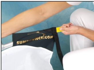
4. Ziehen Sie nun die geschlossene Ecke der Seitentasche über das Rohrende, damit die Bespannung straff gespannt wird. Wiederholen Sie den Vorgang mit dem zweiten Längsrohr auf der anderen Seite der Bespannung.
