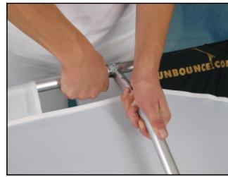
6. Halten Sie den Querbügel fest und ziehen Sie das Längsrohr in Hüfthöhe zu sich heran. Stecken Sie das T-Verbindungsstück in den Querbügel.
