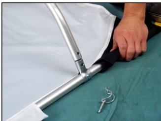
5. Stecken Sie den Querbügel auf ein T-Verbindungsstück am Längsrohr und sichern Sie ihn mit einem SELF-SECURING-PIN.
