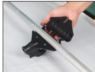
9. Für die perfekte Verbindung zum BOOM-STICK oder Stativ empfehlen wir den SWATTY GRIP-HEAD für 22mm. Befestigen Sie den GRIP-HEAD mittig am Querbügel und ziehen Sie die Schraube fest. Wichtig: Der Querbügel soll sich im GRIP-HEAD drehen lassen.
