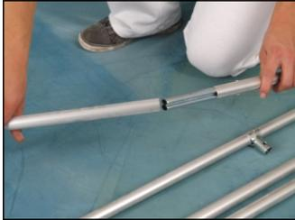
2. Die Längsrohre bestehen aus jeweils zwei Teilen und müssen zuerst zusammengesteckt werden.
